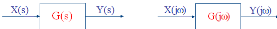
Fig. 9.2 – Diagrama de blocos com os sinais de entrada e saída representados no domínio da frequência.
